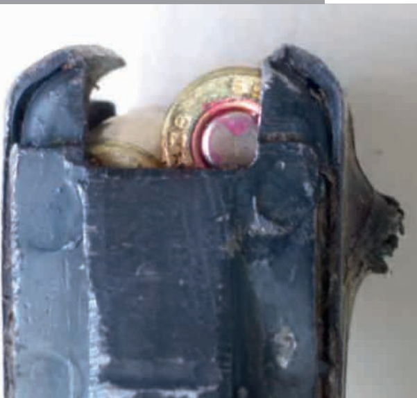
Geladenes Kalaschnikow-Magazin nach Testbeschuss mit MP5 und MP7 – deutlich zu erkennen sind die durch den großen Energieverlust gebogenen Lochränder und der Abpraller der 9mm-Geschosse unten am Magazinboden. Im Bereich der Magazinlippen und in der Mitte des Magazinkörpers sind die fast schon „gestanzten“, scharfkantigen Durchschläge der MP7-Projektile zu erkennen.
